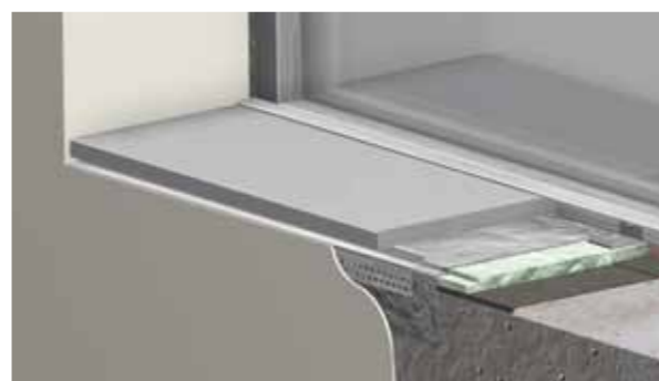
Einbau bei Betonparapet mit verspachtelter Oberfläche
